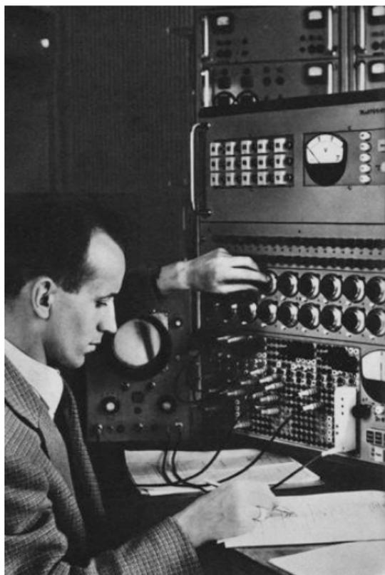
WINKLER, Ingenieur des „Labor Walter“ an einem Telefunken RAT 700 Tischanalogrechner.<sup>7</sup>
